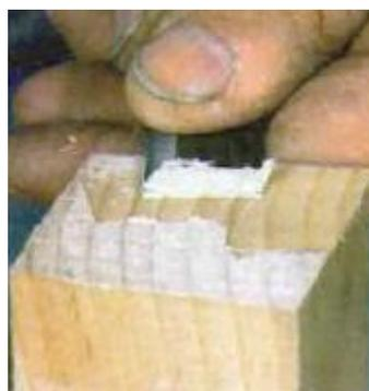
因为软木的木纤维松散,很容易被带离木材表面,只有非常锋利的刃口,才能削出又薄又完整的刨花。削后的横截面应该光滑整齐。当然,有时切削面可能会出现一些轻微的小点,表面有木纤维被带离现象,这表明凿刃
