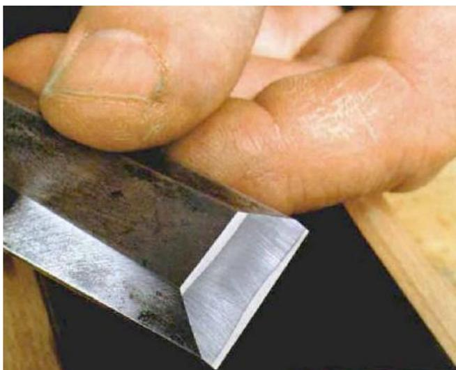
此外,每磨三四次凿子,就轻微打磨一下凿子前端斜面中间部分,使之向内轻微凹入,这样凿子斜面与磨石的接触面小了,会加快打磨速度。(左下图)
